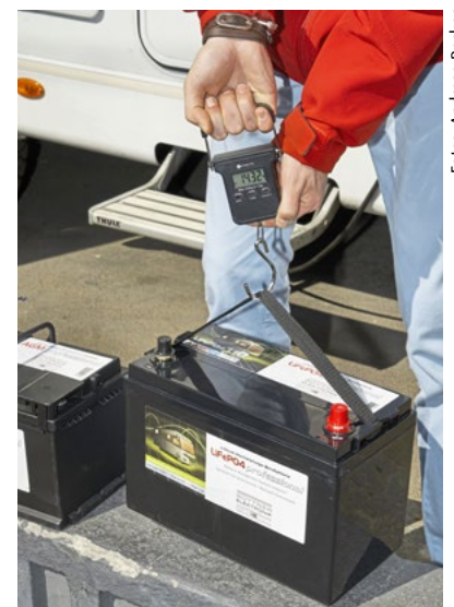
Das LiFeP04 ist 14,7 Kilogramm leichter als die AGM-Batterie. Das ist deutlich.
